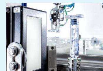
LESUNG UND VERIFIKATION VON SERIALDATEN AUF TRANSPARENTEM ETIKETT
