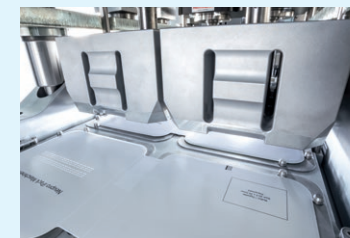
ULTRASCHALLSIEGELN VON KARTONAGE-ZUSCHNITTEN AUF KUNSTSTOFFTRAYS
