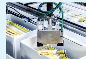
ZIELGENAUER GRIFF IN DIE BOX MIT DER SCHUBERT 3D-KAMERA
