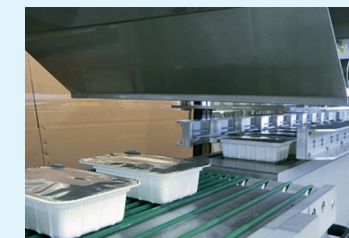
THERMISCHES VERSIEGELN VON KUNSTSTOFFSCHALEN MIT ALUMINIUMKASCHierter FOLIE
