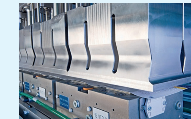
AUFSIEGELUNG EINER BLISTERRÜCKWAND
